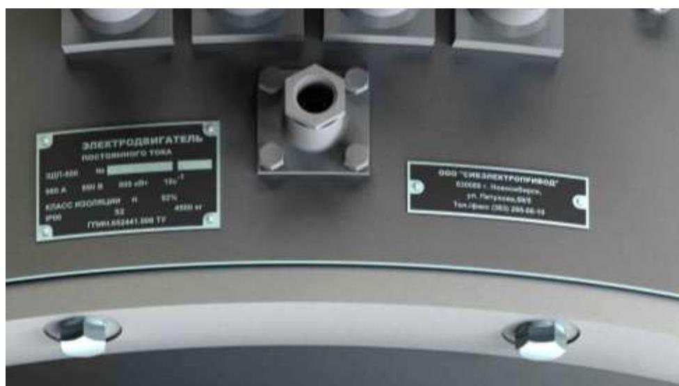
Рисунок 8 – Пример маркировки электродвигателя
