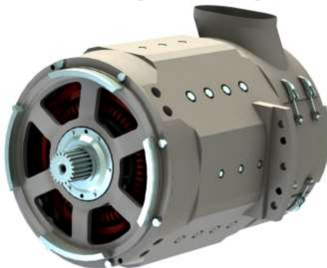
Рисунок 1 – Модель электродвигателя ЭДП-600 (вид со стороны коллектора)
