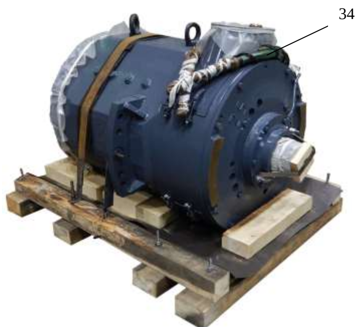
Рисунок 9 – Пример упаковки электродвигателя
