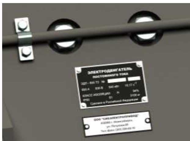
Рисунок 8 – Пример маркировки электродвигателя
